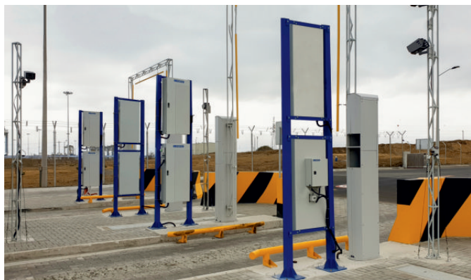
Вариант транспортного монитора в составе: БДРМ-05 (8 шт.), БДКН-05 (8 шт)
