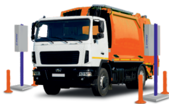
Вариант транспортного монитора в составе: БДКГ-19 (2 шт.), БДКН-05 (2 шт)
